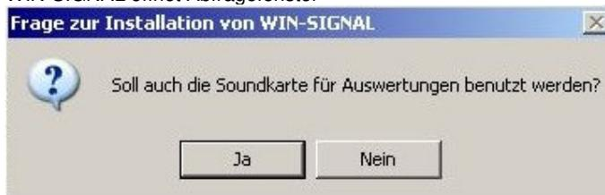
Wenn WIN-SIGNAL lediglich als **Alarmgeber** eingesetzt werden soll, bestätigen Sie mit
