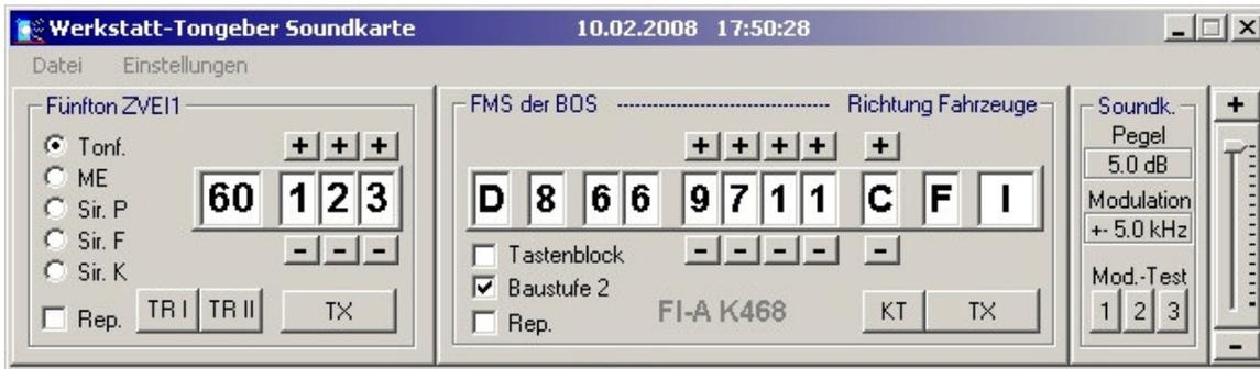
Signalisierungs-Software zur 5-Ton- bzw. FMS-Auslösung von Meldeempfängern, Fernwirkanlagen und Sprechfunkanlagen. Die normgerechte Signalisierung erfolgt über die Soundkarte oder über den Baustein UGA 2000 des Herstellers Funktronic an einen Sprechfunkgeräte-Messplatz.
