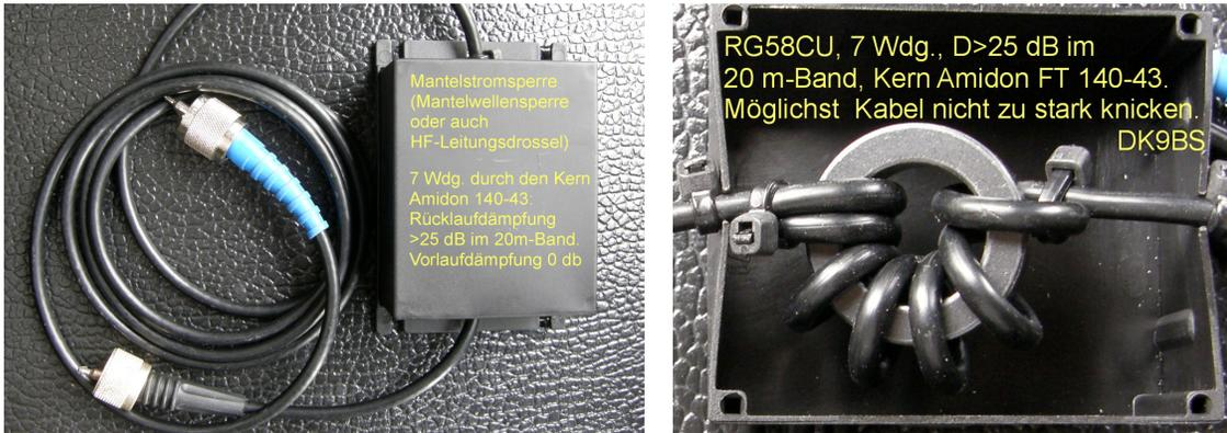
Oftmals lassen sich Modulationsbeeinflussungen, hervorgerufen durch vagabundierende Hochfrequenz im Nahfeld des Senders, mit dieser leicht selbst herzustellenden Mantelstromsperre beseitigen.
